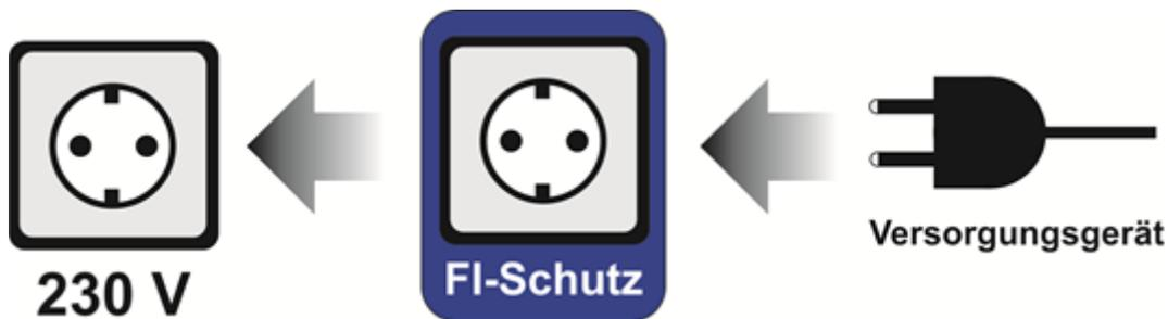
*Gráfico: Tener presente el orden secuencial: Enchufar el conector intermedio con protección de personas mediante interruptor diferencial FI en el enchufe de la red eléctrica. Enchufar el dispositivo de alimentación en la toma del conector intermedio con protección de personas mediante interruptor diferencial FI.*
