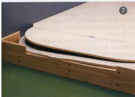
Für den Trassenverlauf der Wendeschleifen-Zufahrt wurde der Außenrahmen im linken Bereich großzügig ausgespart, um der Rampenstrecke den erforderlichen Platz zu verschaffen.
