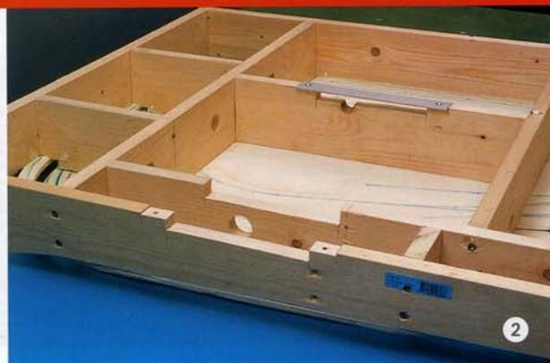
Hier sind aus den Rahmenteilen 2, 9 und 11 bereits die Aussparungen für die Trafo-Schublade und die beiden Alu-Gleitschienen herausgearbeitet. Die genauen Maßangaben zeigt Skizze 2.
