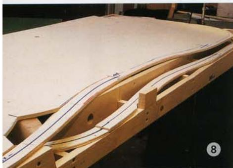
Der vordere Trassenplatten-Rand orientiert sich am benachbarten Bahnhofsgleis-Verlauf. Ferner ist beim Zuschnitt genügend Einbau-Freiraum für das untere Tunnelportal und ein Trassenstück in Richtung Brücke zu berücksichtigen.
