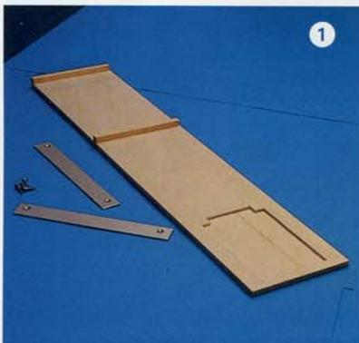
Aus zwei 4-mm-Sperrholzschichten verleimte Trafo-Lade. Im oberen Teil befindet sich eine zur Trafogrundfläche passende Aussparung, in der die Stromversorgung sicher liegt. Zu sehen sind auch die beiden Alu-Gleitschienen.
