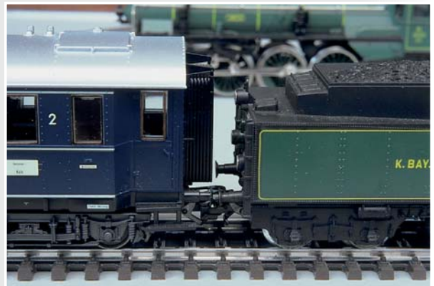
Sowohl das feinfühlige Kuppelverhalten als auch der geringe Fahrzeug-Abstand entschädigen für die Mühe des Kulissen-Einbaus.
