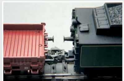
Der Kurzkupplungs-Umbau verkürzt zwar den Kuppelabstand gegenüber der Ursprungsausführung nicht, erleichtert aber das Ankuppeln.
