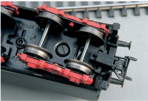
Lokomotiv-Tender der Baureihe 23 nach dem abgeschlossenen Kurzkupplungs-Umbau.
