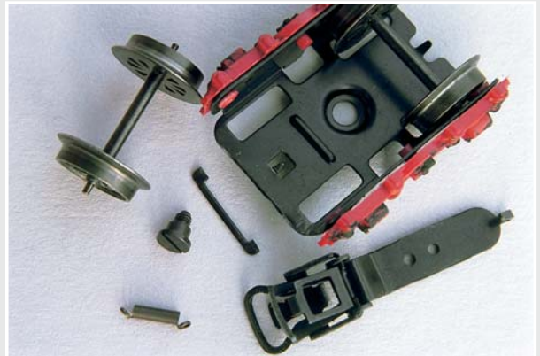
Die Höhenführung der Metallkupplung ist bereits abgetrennt und der Deichsel-Haltesttiff flach gedrückt.
