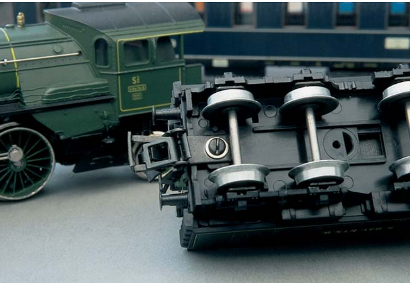
Am Drehzapfen angelenkte Original-Metallkupplung des Tenders der S 3/6 (alias Baureihe 18.2).
