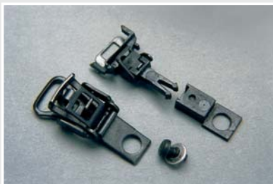
Um eine zentrierte Aufnahmebohrung zu erhalten, sollte man zu deren Erweiterung den Schacht 288390 in einem Bohrständer bearbeiten.
