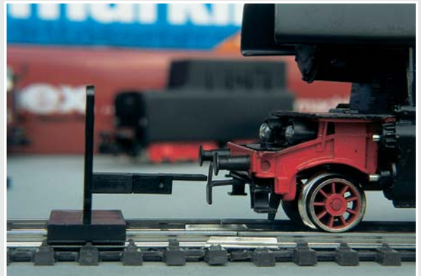
Auf der Justiereinheit steckt ein Märklin-Schacht 288390. Wie die Probe verdeutlicht, ist eine Montage in korrekter Höhe nicht möglich.
