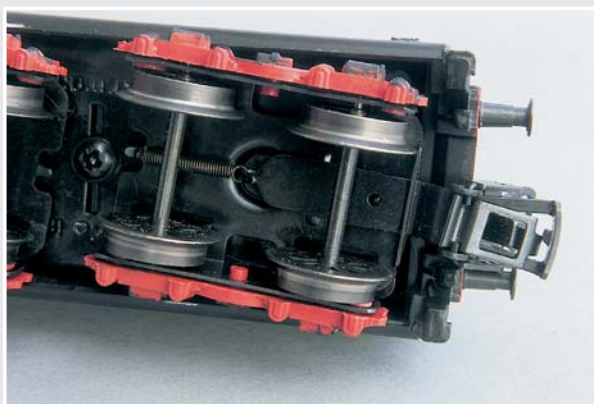
Die Kupplung ist an einem Stift gelagert und wird durch eine Feder in korrekter Mittelstellung gehalten.
