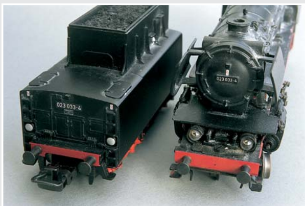
Wie alle Märklin 23-er, besitzt auch die Primex 33005 eine Metallkupplung am Tender.
