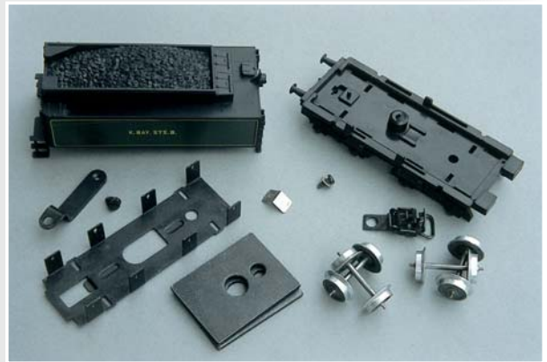
Für den Einbau einer Kulissenführung muss der S 3/6-Tender komplett zerlegt werden.
