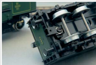
Mit wenigen Handgriffen ist der Schacht 288390 jetzt am Tender der S 3/6 montiert.
