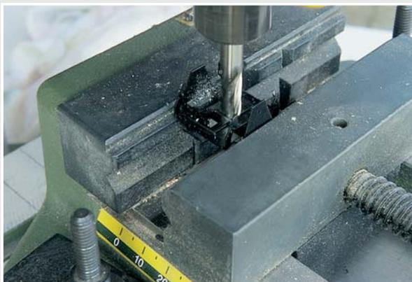
Eine Fräseinrichtung mit Kreuztisch erleichtert das Einebnen der vorgesehenen Klebefläche.
