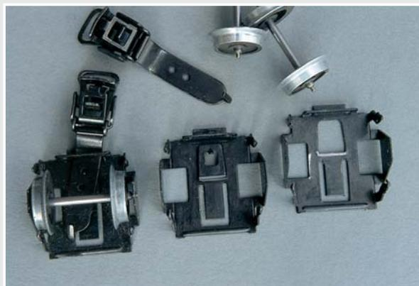
Arbeitsschritte am Achshalter. Das nach unten weisende Federblech wird einfach „geglättet“.
