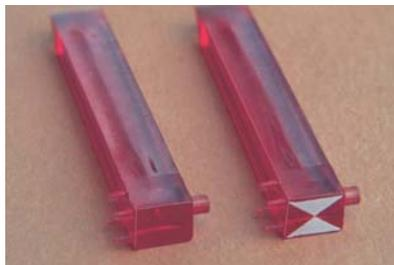
Am linken Lichtleiter wurde der Schlusssignal-Aufdruck bereits entfernt.
