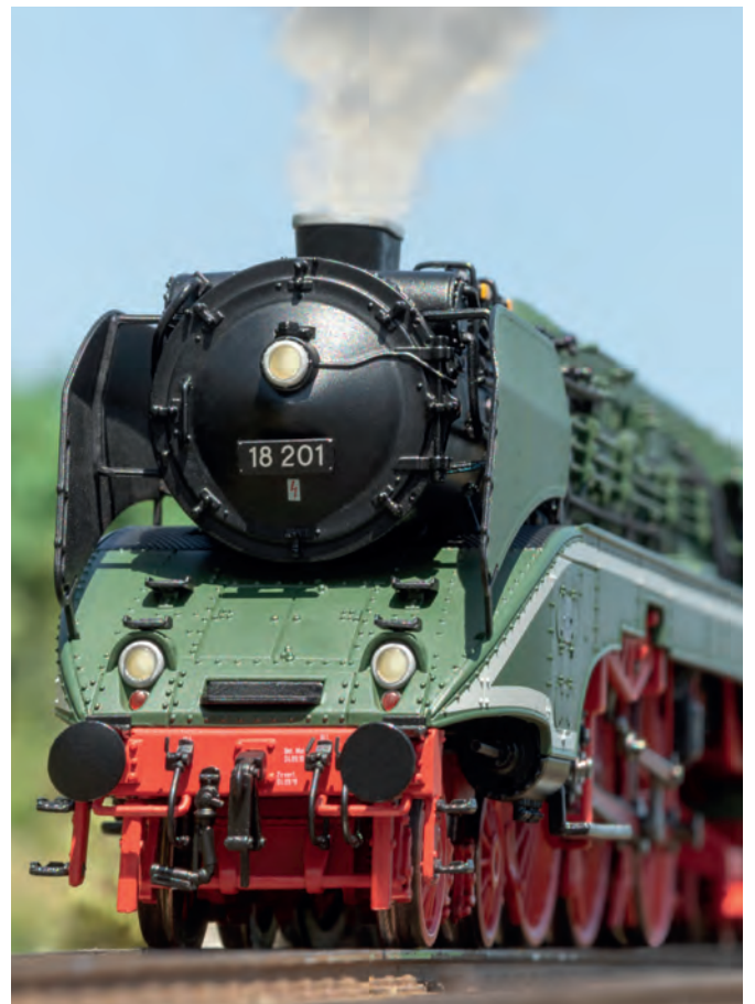
Ein Raucheinsatz mit geschwindigkeitsabhängigem dynamischem Dampfausstoß sorgt für vorbildgerechten Fahrspaß.
