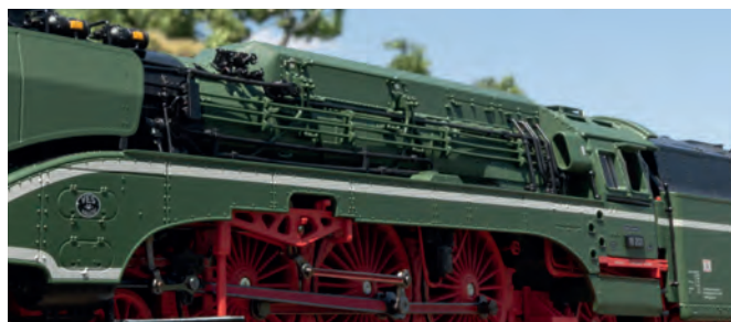
Die besonders filigrane Metallkonstruktion der Lok zeigt viele angesetzte Details wie Rohre, Ventile oder Handräder.
