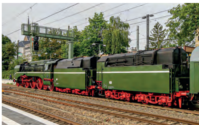
Bei einem Zwischenhalt im Bahnhof Solingen zeigt die 18 201 ihren Doppeltender, der längere Fahrten möglich macht.
