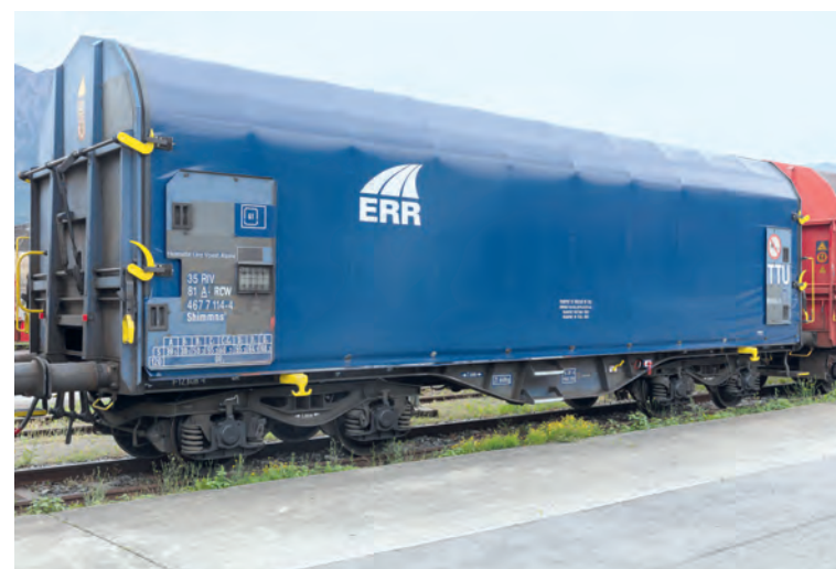
Coiltransporter des Wagenvermieters ERR (European Rail Rent GmbH). Das Anschriftenfeld verrät, welches maximale Ladungsgewicht je nach Streckenklasse, also A bis D4, in den Planenwagen verladen werden darf. Die Aufnahmen entstanden im Bahnhof Buchs SG.
