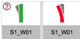
Der Ablauf realisiert ein bedingtes Schalten von Weichen. Der erste Schritt realisiert die Abfrage der aktuellen Stellung der Weiche. Dies erkennt man an dem Fragezeichen am linken oberen Ende des Symbols. Die Einstellung ist **Bedingung fortfahren, wenn Stellung der Weiche auf geradeaus ist**. Steht die Weiche derart, wird der 2.te Befehl ausgeführt und die Weiche geschaltet.
