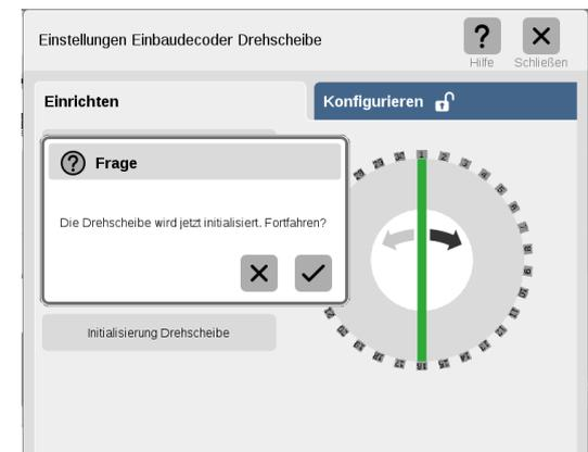
Die vorhandenen Gleisanschlüsse werden automatisch erkannt und können dadurch direkt ausgewählt werden.
