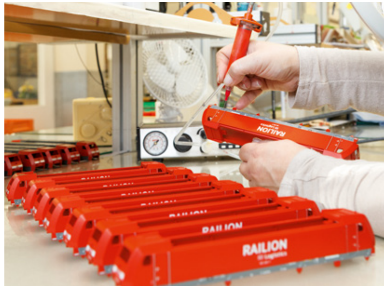
Gleichmaß: Um Vertiefungen am Gehäuse der E-Lok BR 185.2 farblich auszuliegen, wird eine Dosiermaschine mit Luftdruck verwendet – die Farbmenge bleibt immer konstant.
