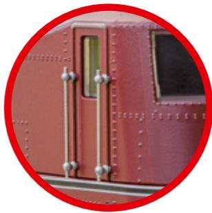
Über der weiß abgesetzten Zierlinie die detailliert ausgeführte Führerstandstür.
