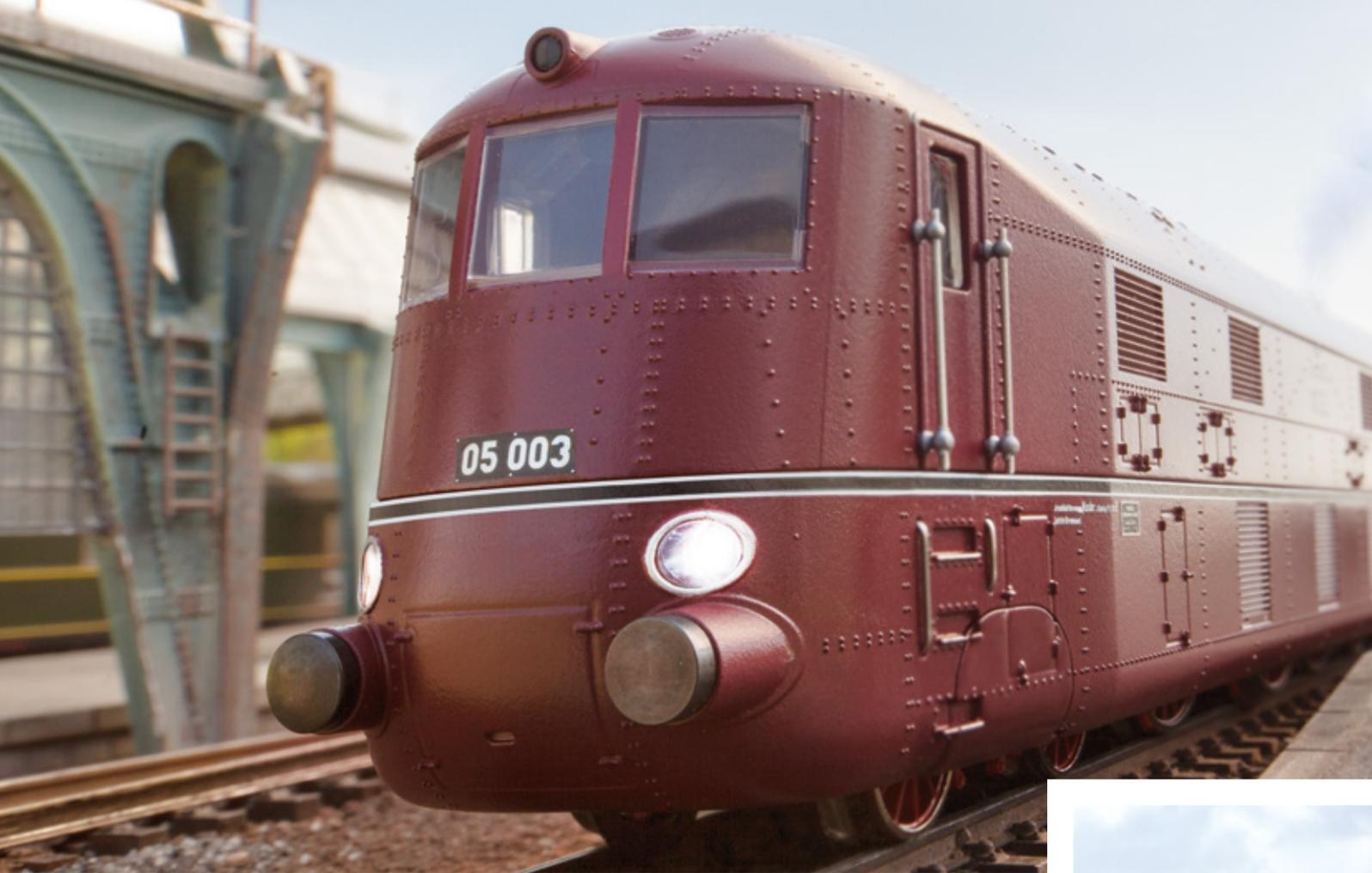
Führerstand voraus, Schornstein zum Tender: Die Stromlinien-Dampflok 05 003 – eine außergewöhnliche Lok in einer außergewöhnlichen Baureihe.
