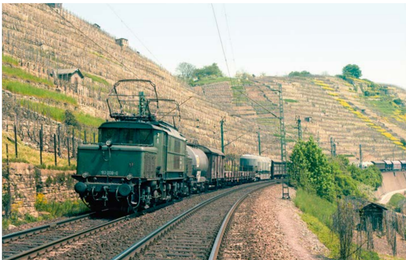
Gewaltige Laufleistung: Die Loks der E 93 spulten zum Teil über 13.000 Kilometer im Monat und zogen lange Güterzüge.
