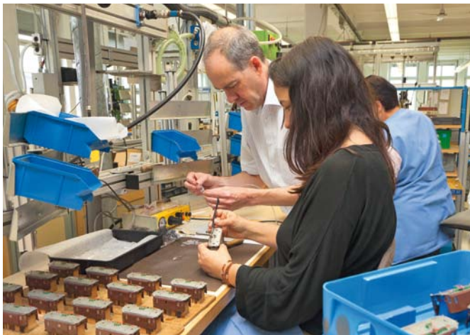
Höchste Konzentration: Verbiegt sich eine zu filigrane Leitung in der Montage? Läuft die Bemalung störungsfrei? Qualitätssicherer interessiert alles.
