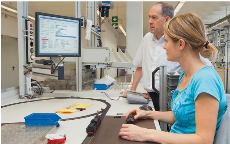
Grenzwerte: Der Bildschirm verrät in der Endabnahme, ob Funktionen von Lok und Tender in der engen Toleranzzone liegen. Das artikelspezifisch ausgearbeitete Prüfprogramm ...
