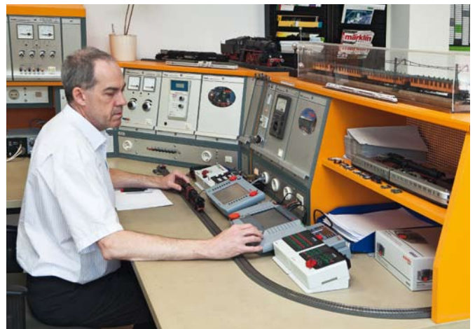
QS-Leiter Schork: „Unsere Qualitätsstandards beschreiben alle Merkmale einer Lok.“ Die Probe aufs Exempel geschieht am komplexen Prüfstand.
