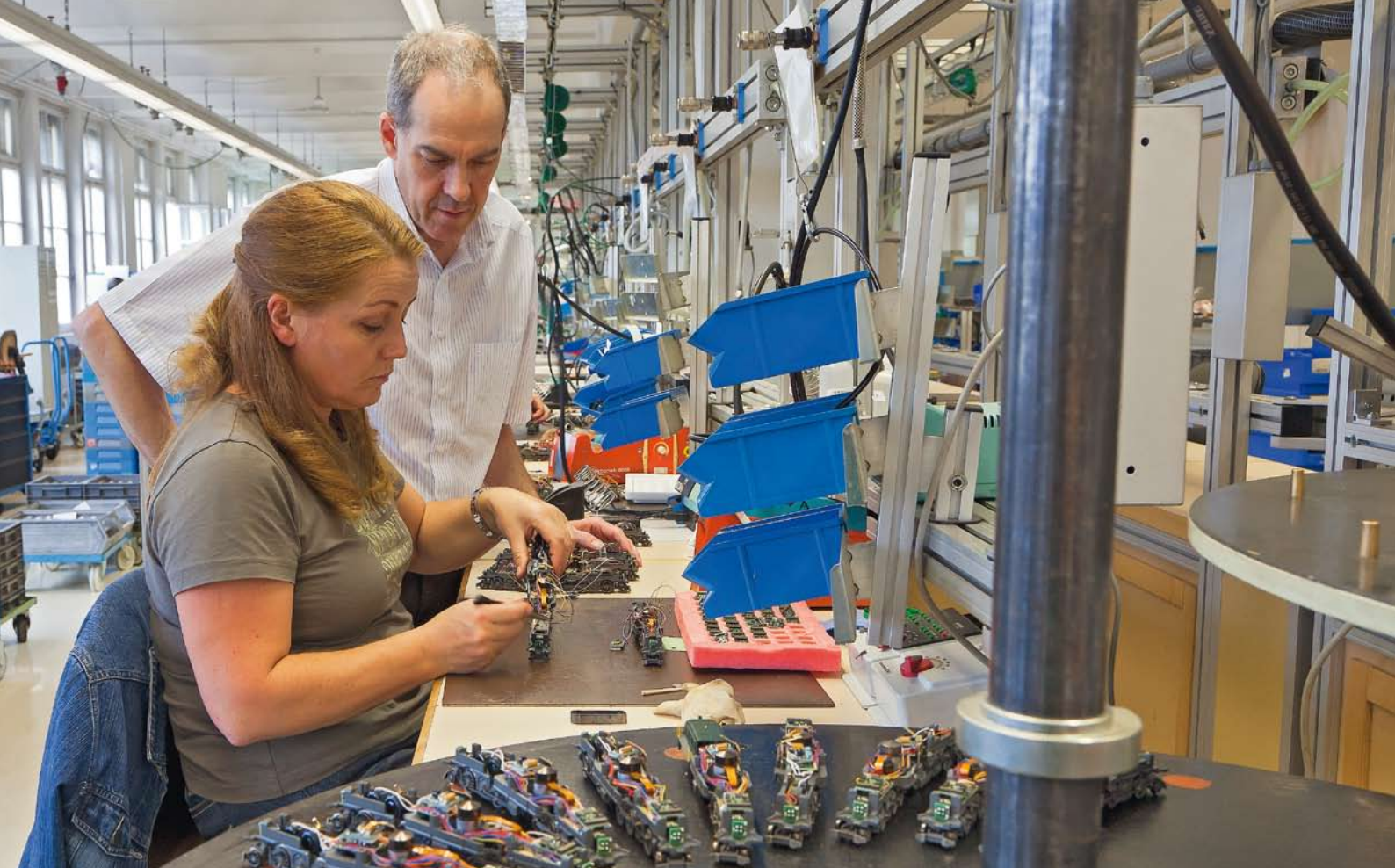
Letzter Montageplatz vor der sogenannten Hochzeit: Die Verbindung von Lokunterbau und Aufbau zeigt erstmals das komplette Modell. Die Montage ist damit beendet – und wird natürlich noch in einem Bericht dokumentiert.
