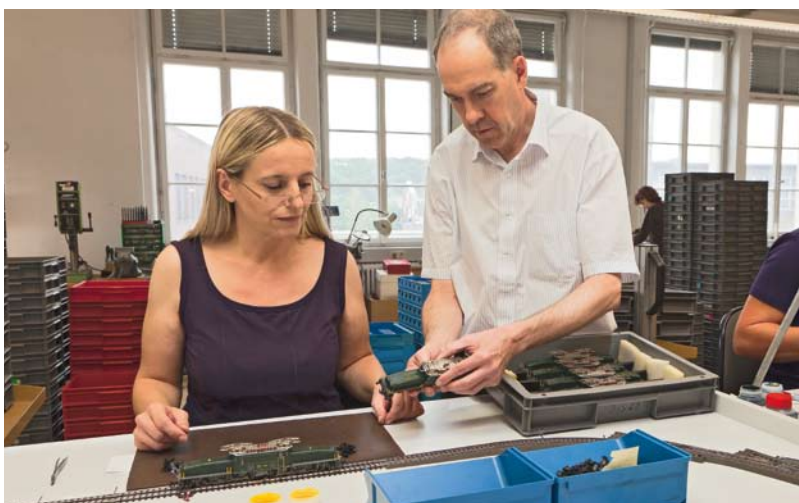
... achtet auf Tempo, Fahrtrichtung, Stromaufnahme, Sonder- und Soundfunktionen. Abschließend findet eine optische Inspektion der Anbauteile und Farbgebung statt.
