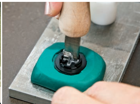
In die Rückseite der Rauchkammertüre wird mit einem Spezialwerkzeug der Lichtkörper gedrückt.
