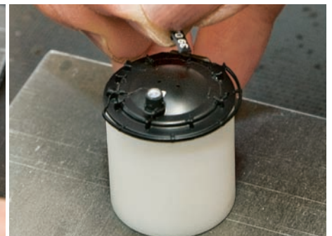
Das Einsetzen des fertig bedruckten Nummernschildes in die Rauchkammertüre erfolgt mit Hilfe einer Vorrichtung.
