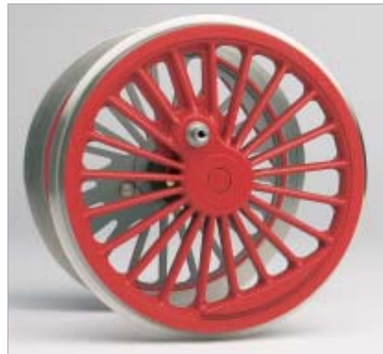
Einer der gewaltigen und extrem filigranen Radsätze in Originalgröße. Man beachte die »Schwimmhäute« zwischen den Speichen.
