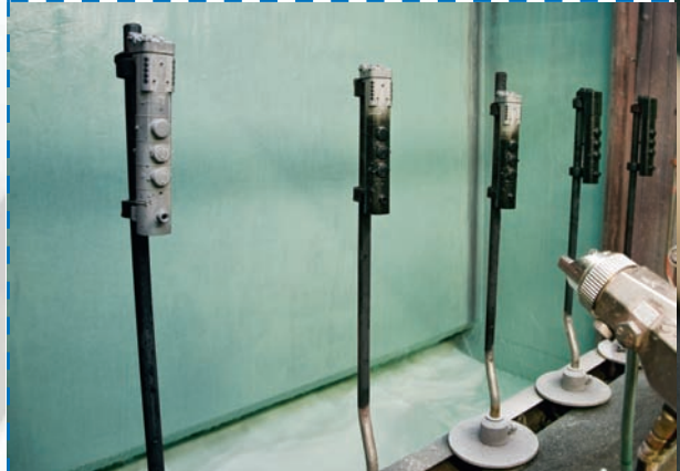
Bild oben: Die oberflächenbehandelten Kessel erhalten ihren Haftgrund und Decklack aus Wasserlack.
