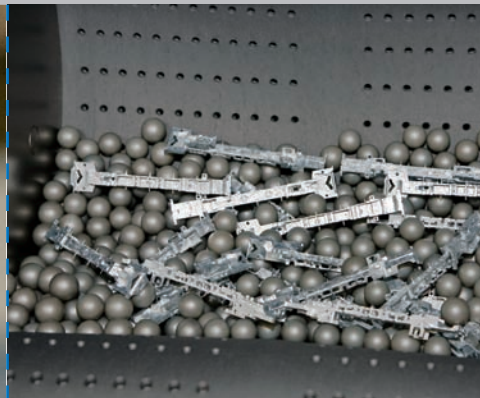
Bild links: Die Gussgestelle werden in der Strahlmaschine auf schonende Art gratfrei gemacht. Kunststoffkugeln verhindern das Aneinanderstoßen in der Trommel.
