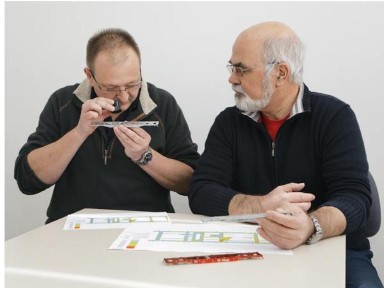
**Lupenrein:** Bei Aufnahmebohrungen des H0-Wagenboden-Rohteils 145807 arbeiten Kinzel (links) und Schmidt im Bereich von Hundertstelmillimetern.
