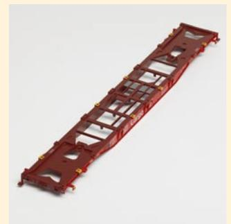
**Stufe 4:** In der Malerei wird der Wagenboden mit Grund- und Decklack versehen sowie mit weiteren Farbstufen für Varianten. Bedruckt wird in 48 Arbeitsgängen.
