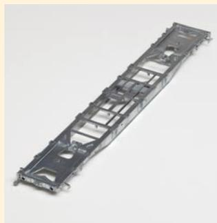
**Stufe 2:** In der Gussbearbeitung wird das Teil bürsttechnisch und mechanisch entgratet. Teilweise wird auch CNC-bearbeitet hinsichtlich Bohrungen für Anbauteile.
