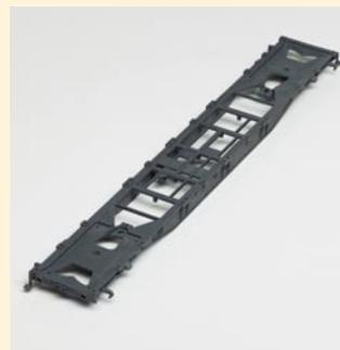
**Stufe 3:** In der Galvanik erhält die Oberfläche mit einer Phosphatlösung eine Schutzschicht gegen Korrosion und zur Verbesserung der Farbhaftung.
