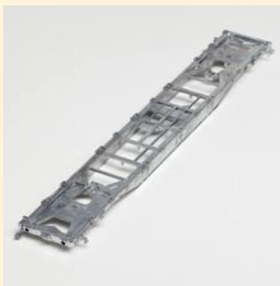
**Stufe 1:** Der Zinkdruckguss-Rohling kommt stabil, aber 250 Grad Celsius heiß aus der Form und wird nach Abkühlung sofort einer visuellen Prüfung unterzogen.
