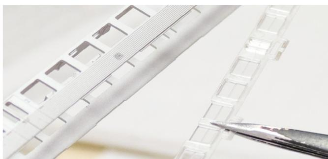
**Handarbeit:** Feinfühlig wird die durchgehende Fensterreihe mit der Pinzette in den Wagen eingesetzt.
