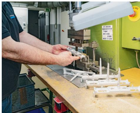
**Kontrolle:** Ein Mitarbeiter prüft das Gussteil unter der Lichtlupe (Bild links) zu 100 Prozent auf Oberflächenfehler – sind keine Luftporen, Kaltflusslinien oder Folgen einer defekten Form festzustellen, wird der Überguss entfernt. Die Entlüftungsbohnen unten werden meist per Hand abgebrochen, die dicke Säule des Angusses wird mit einem Pressenwerkzeug (Bild rechts) ausgeschnitten oder abgesägt.
