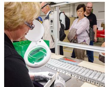
**Manuelles Entgraten:** Um stärkere Formtrennrate zu entfernen, Kanten abzufahren oder Durchbrüche wie Fenster oder Wagenboden zu entgraten, wird mit Schabern, Feilen oder Schmirgelholz (rechts) gearbeitet. Es ist formtechnisch unmöglich, im Druckguss komplett gratfreie Teile herzustellen.
