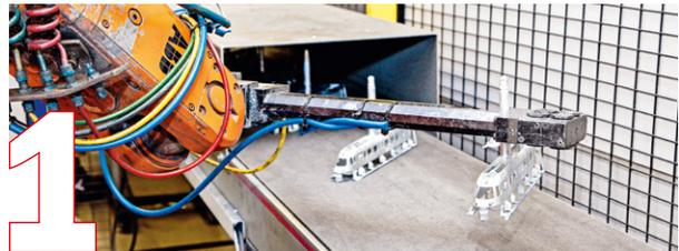
**Abkühlung:** Frisch aus der Form werden die je nach Masse 250 bis 280 Grad Celsius heißen Gussteile von einem Roboterarm auf ein Band gelegt und durch einen Kühlkanal mit Luftgebläse geführt.
