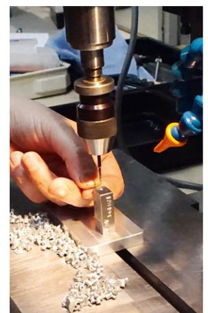
**Bohren/Fräsen:** Im CNC-Bearbeitungszentrum (BAZ) werden Öffnungen für Ansteckteile gebohrt, Gewinde geschnitten und Überschuss abgefräst. Ist etwa nur ein Gewinde erforderlich, erledigt das die Handgewindemaschine (rechts) schneller – zudem ist der Arbeitsprozess im BAZ kostspielig und programmieraufwendig.
