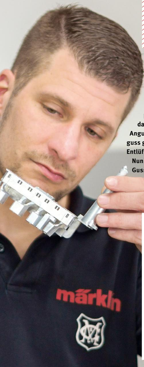
Eine von Märklins Kernkompetenzen ist der Zinkdruckguss. Schichtführer Michael Krix prüft ein Gehäuse, das er am massiven Anguss hält. Zum Überguss gehören auch die Entlüftungsbohnen unten. Nun übernimmt die Gussbearbeitung.
