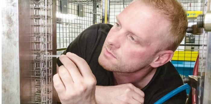
**Spiegelglatt:** Das Werkzeug für die Fensterglaserstellung ist hochglanzpoliert und besitzt eine Oberflächenrauheit von 0,04 Mikrometer. Deshalb sorgt Stefan Eckert, Leiter der Abteilung Spritzguss bei Märklin, für einen vorsichtigen Umgang mit den Formen.
