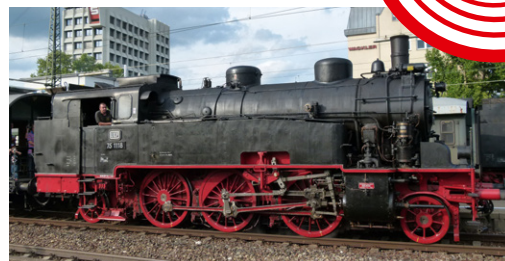
Zu Gast bei IMA/Märklin Tage 2017: die 75 1118 des UEF, eine badische VI c mit geschweißten Wasserkästen.
