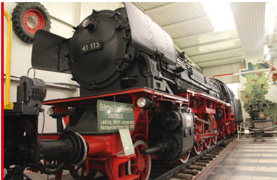
Die 41 113 ist eine Museumslok des Clubkooperationspartners Technikmuseum Sinsheim ( https://sinsheim.technik-museum.de ). Die Maschine besitzt einen Neubaukessel und war auch auf eine Ölhauptfeuerung umgebaut worden.
