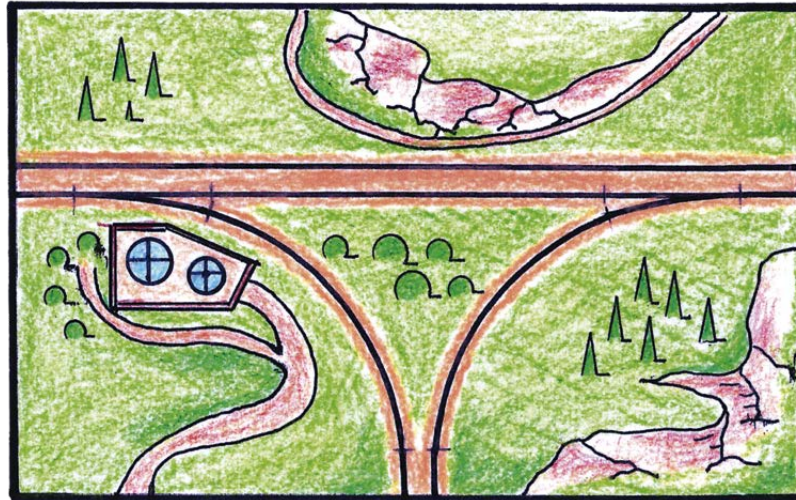
T-Anschluss: Mit zwei Weichen öffnet das Abzweigmodul die Strecke und gibt der Anlage eine neue Richtung. Landschaftlich und technisch ist es einfach gehalten.
