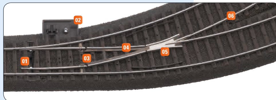
01 Afzonderlijk gelagerde, gegoten wisseltongen 02 Voorbeeldgetrouw metselwerk bij het stelmechanisme 03 Ononderbroken contact van de tongen tot het puntstuk 04 Tussenrails van profielmateriaal 05 Ingezet puntstuk vsm metaal 06 Wisselbogen als cirkelsector 30°, radius 360 mm
