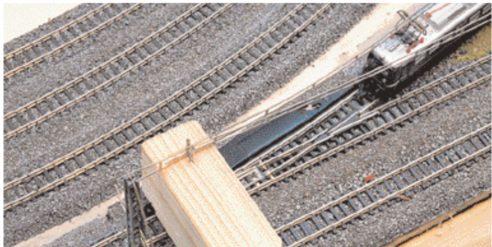
Der Übergang zur freien Strecke: Vom Bahnhof aus wird die Leitung weitergeführt. Die Distanzklötzchen mit den eingeschlagenen Nägeln halten den Fahrdrabt exakt in der vorgesehenen Lötposition.
