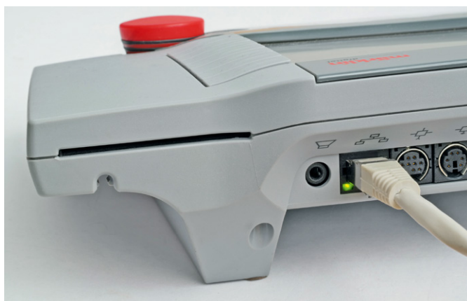
1) Für den Einsatz der PC-Software wird die CS2 ganz einfach per Ethernetkabel an einen Heimnetzrouter angeschlossen.
