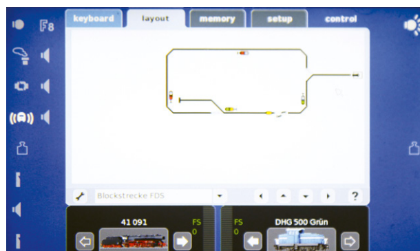
Nach dem Speichern erscheint der Bildschirm im Bedienmodus. Die Kontakte sind weiß, erst nach dem Aktivieren leuchten sie gelb.
