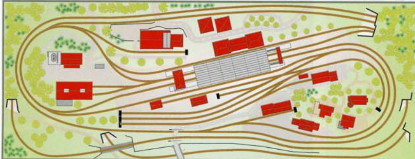
Unsere geplante Z-Anlage auf einer Grundfläche von 190 x 72 cm.
