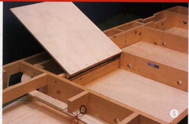
Schwenkladen-Einbauposition im Anlagenrahmen. Indes handelt es sich immer noch um die vereinfachte Ausführung ohne Anschlagbrettchen, bei der in eingeklappter Position Stellpult-Aufbauten an der Rahmen-Unterseite heraus ragen.
