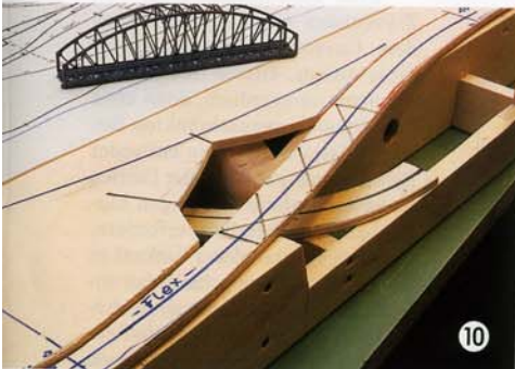
Zur Böschungs-Geländegestaltung im Brücken-/ Tunnelbereich erhält unter Berücksichtigung des oberen Flexgleis-Verlaufs auch die obere Trassenplatte eine möglichst große Aussparung. Der Ausschnitt zum Brückeneinbau ist bereits markiert.
