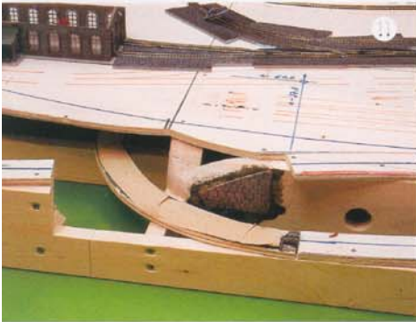
Für den Brücken-Einbau wird das aufgezeichnete Trassen-Teilstück auf einer Länge von 22 cm mit einer fein gezahnten Säge herausgetrennt. Die großzügige „Auslichtung“ angrenzender Rahmenteile schafft Freiraum für das landschaftliche Umfeld.
