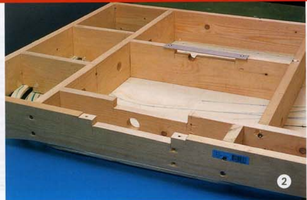
Hier sind aus den Rahmenteilen 2, 9 und 11 bereits die Aussparungen für die Trafo-Schublade und die beiden Alu-Gleitschienen herausgearbeitet. Die genauen Maßangaben zeigt Skizze 2.
