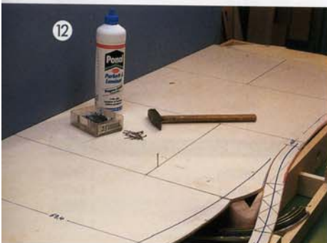
Die auf den Rahmen aufgelegte Platte wartet auf ihre endgültige Befestigung. Bleistiftlinien markieren den Verlauf der stützenden Innenstreben. So treffen bei der „blinden“ Fixierung die Nägel sicher ihr Ziel.
