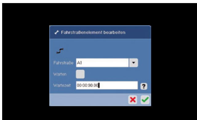
Über ein Eingabefeld lässt sich die Wartezeit definieren, bis der nächste Befehl in der Fahrstraße abgearbeitet wird.
