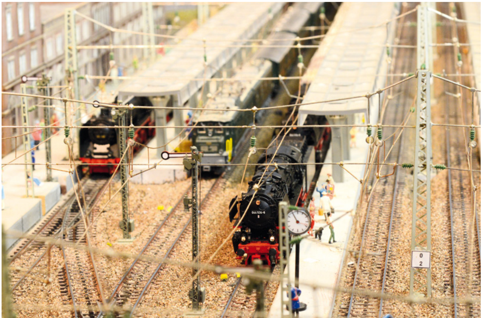
Der geübte Blick erkennt es sofort an den zahlreichen Formsignalen: Dieser Bahnhof stammt noch aus der Epoche vor dem Zweiten Weltkrieg. Nach 1945 entwickelten beide deutsche Staaten Relaisstellwerke, die mit Lichtsignalen arbeiten.
