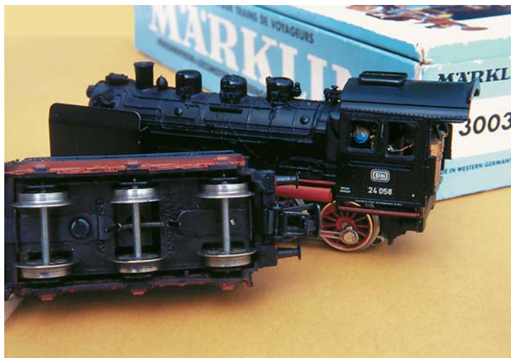
Am Tender der Dampflok BR 24 entdeckt man das gleiche Fahrgestell wie beim Tiefladewagen. Dies legt auch hier den Einbau einer Kurzkupplungskulisse nahe
