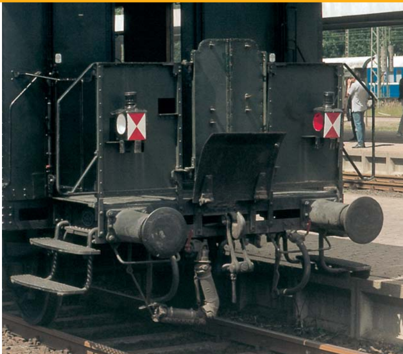
Dieser Personenwagen erhielt für eine Sonderfahrt zwei Schlusslaternen. Es ist eine weiße und eine rote Lichtaustrittsöffnung zu erkennen.
