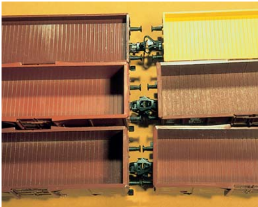
Der Längenvergleich zeigt von oben nach unten: serienmäßige Relex-Kupplung, Kurzkupplung aus 7205 und Kinematik-Kurzkupplung mit Symoba-Umbau
