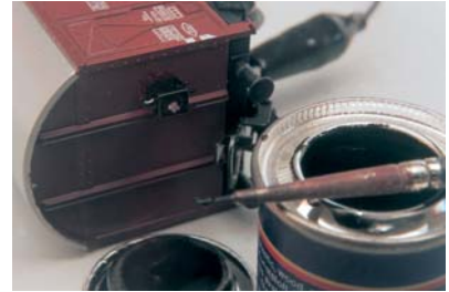
Zum Abdunkeln der Laterne wurde das Element etwas aus der Halterung herausgezogen, um den Aufbau vor einer Pinselberührung zu bewahren. Ferner wird die Lichtundurchlässigkeit der Lackschicht überprüft.
