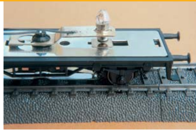
Durch Andruck hält die Glühlampe den Massekontakt. Beim Umbau auf die Lampenfassung 604180 oder eine LED-Beleuchtung ist diese Kontaktflasche mit Klebstoff zu fixieren.
