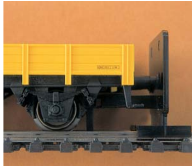
Zur Kupplungsdeichsel-Einstellung stellt man Wagen und Lehre auf ein gerades K-Gleis. Berühren die Pufferteller den Anschlag der Justiereinheit, so sind Rangierfahrten über steile Weichen zu vermeiden
