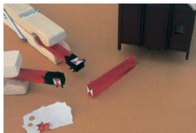
Diese Schlusszeichen wurden mit einer „Maskierung“ und aufgemalter Farbe hergestellt. Ohne Airbrush sind auch mit dem Pinsel gute Erfolge zu erzielen.
