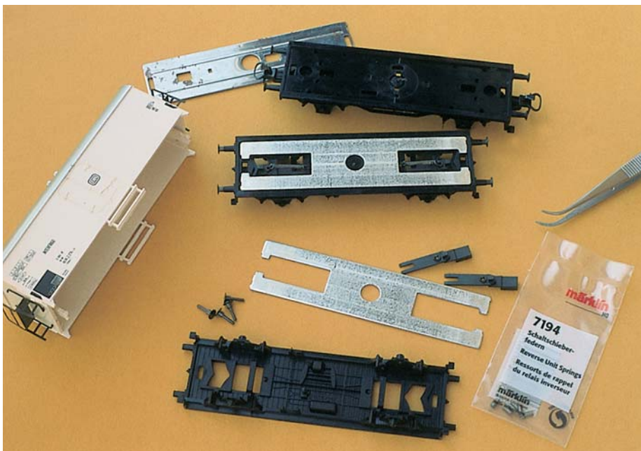
Die erforderlichen Tauschteile auf einen Blick. In der Mitte sind sie bereits montiert. Oben ist der alte Wagenboden zu sehen
