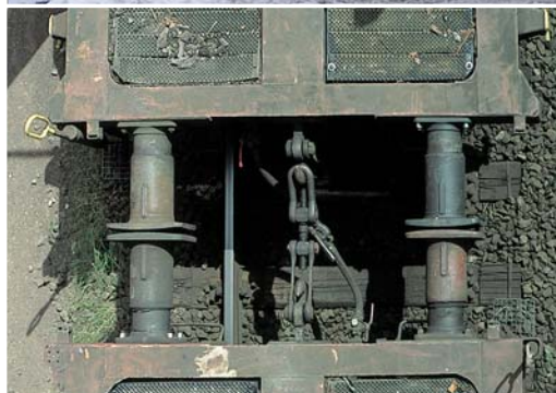
Wagenverbindung mit Schraubenkupplung hier im Original: Zu beachten sind die diagonale Bremsschlauch-Verbindung und die verschiedenfarbigen Puffer
