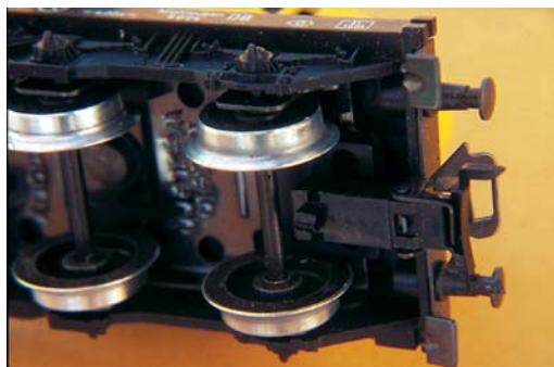
Nach abgeschlossenem Einbau und Justierung wurde bereits der Stift an der Kulissenführung gekürzt
