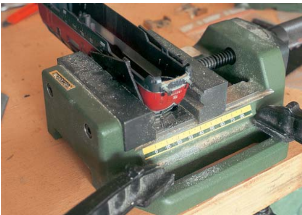
Für die KK-Umrüstung ist die Gehäuse-Bearbeitung unumgänglich. Das Einspannen muss jedoch sehr gefühlvoll vorgenommen werden, da sonst die Flanken dem Druck des Schraubstockes nachgeben
