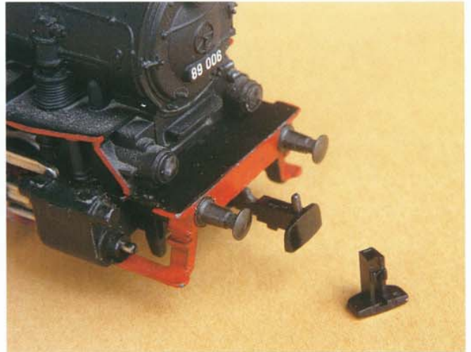
Die Prallplatte rastet beim Aufsetzen auf den Kupplungshaken mit einem leisen „Klick“ ein
