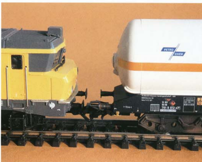
Das Kuppelverhalten ist einwandfrei, der Abstand bei der Verbindung mit einem kulissengeführten Wagen noch vertretbar
