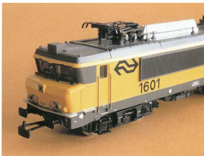
Der Kupplungshaken an dieser holländischen E-Lok kann gegen die Kupplungsdeichsel 404020 getauscht werden
