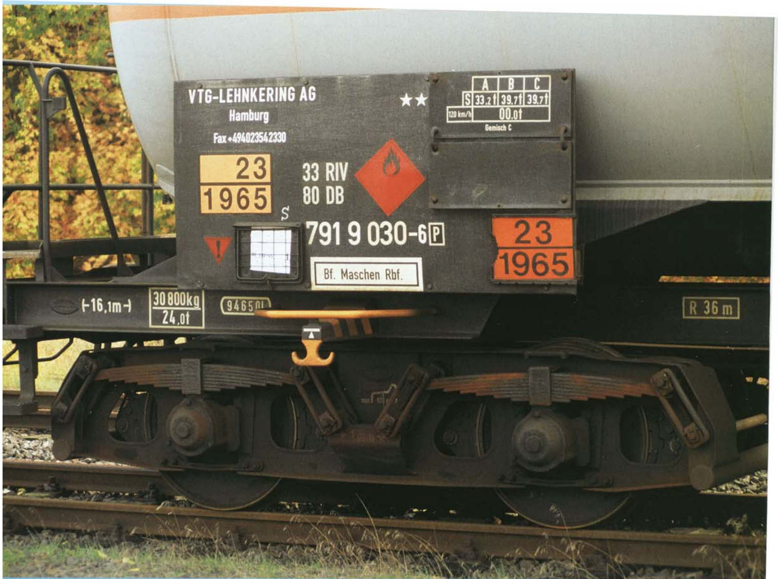
Zahlreiche Warntafeln weisen auf die Gefahr hin: In diesem Kesselwagen wird Kohlenwasserstoffgas transportiert
