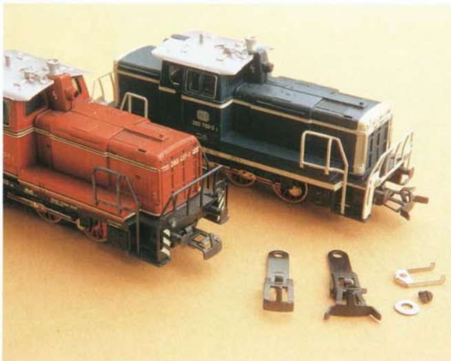
Die Baureihe 260, rechts noch vor, links nach dem Umbau. Zum Vergleich auch je eine alte und neue Kupplungsdeichsel
