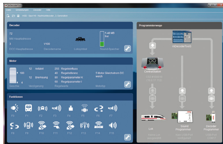
Einfach zu bedienen: die Programmiersoftware mDT3 – hier das zentrale Management-Cockpit (Dashboard). Beim Datentransfer kann man per Mausklick wählen, wie die Einstellungen übertragen werden sollen: direkt auf den Decoder oder via Central Station auf die Lok (Feld rechts im Dashboard).
