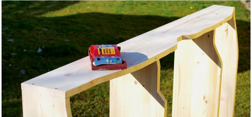
Leicht und stabil: In der Spantenbauweise entsteht der Unterbau. Sechs Spanten werden ausgeschnitten sowie verleimt und verschraubt.
