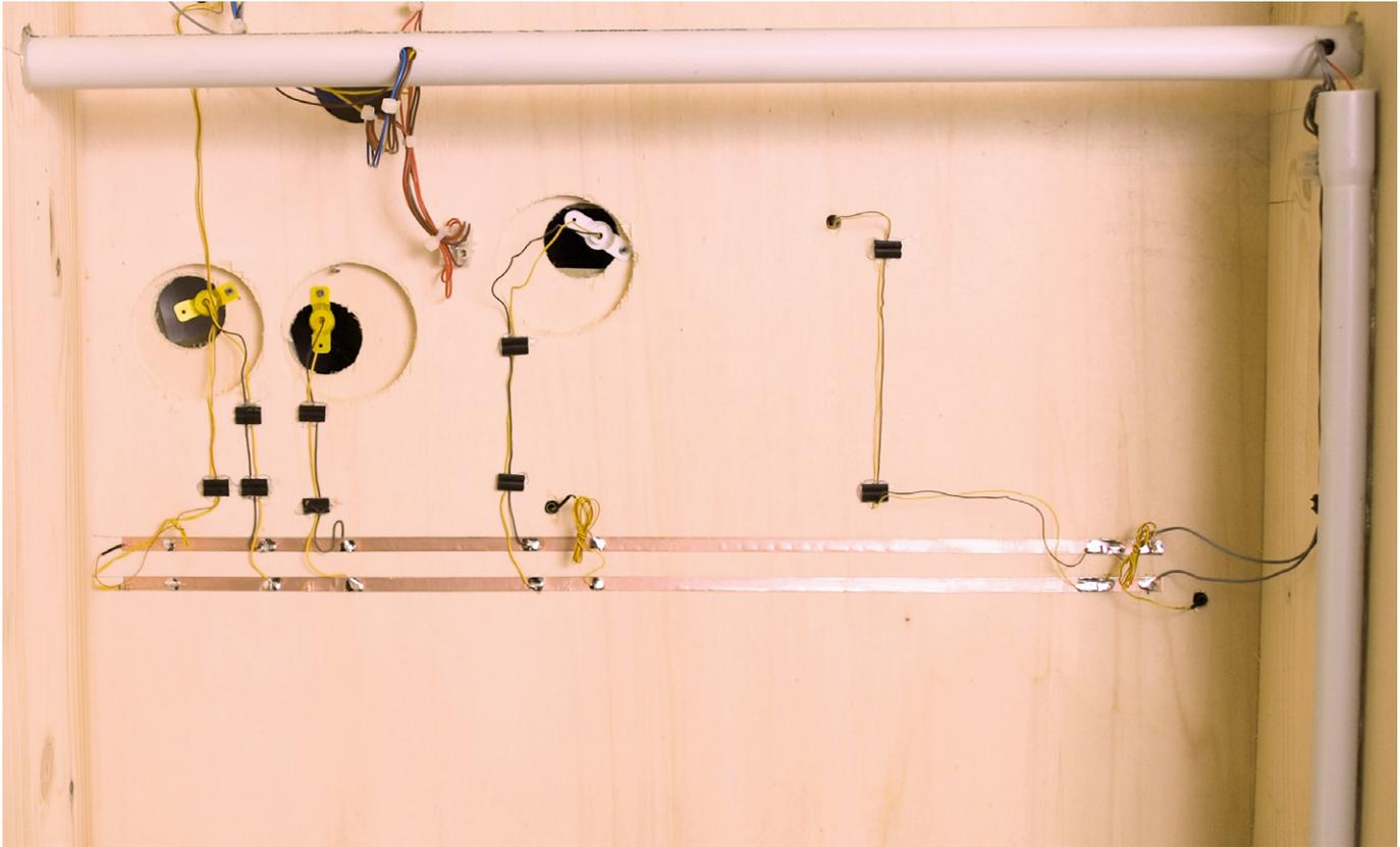
**Stromführung auf der Unterseite der Anlage: Alle Verbraucher werden an zwei Kupferbänder angelötet, die wiederum mit der Gleisbox der MS2 verbunden sind. Kabelkanalstücke helfen dabei, die Verkabelung übersichtlich zu halten.**
