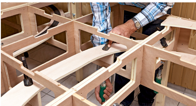
Der Schienenweg entsteht: Die Trassenbretter werden eingesetzt und mit den Abstandshölzern bzw. den Rahmenbrettern verleimt.
