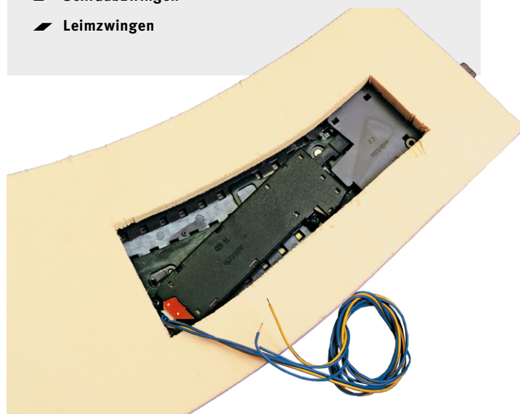
Trassenbrett mit Wartungsöffnung: Auch im fest verbauten Zustand kann nun jederzeit der Weichenantrieb ausgetauscht werden.
