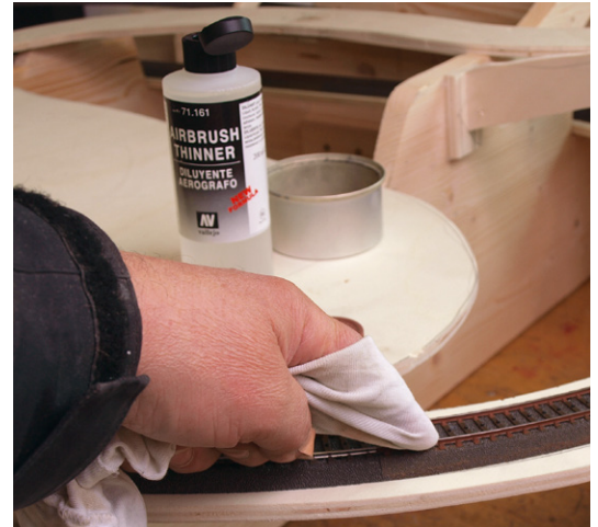
Ein weiches Tuch mit Aceton befreit die Schienenoberkante wieder von der Farbe.
