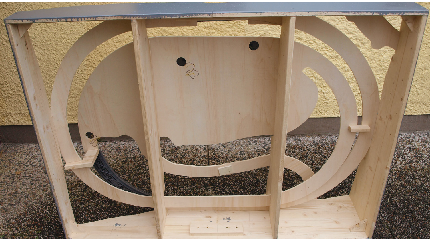
Der Unterbau von unten: Die eingesetzten Trassen wurden an zwei Stellen zusätzlich befestigt. In der Ecke links unten ist die gebogene Brücke zu sehen, im Bereich rechts unten ist der Tunnel eingepplant.
