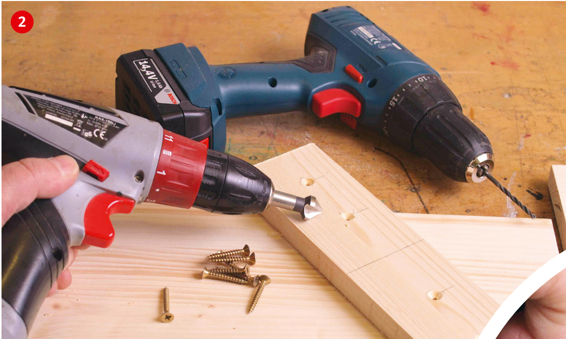
Der Unterbau entsteht: Die Spanten werden verleimt und verschraubt.
