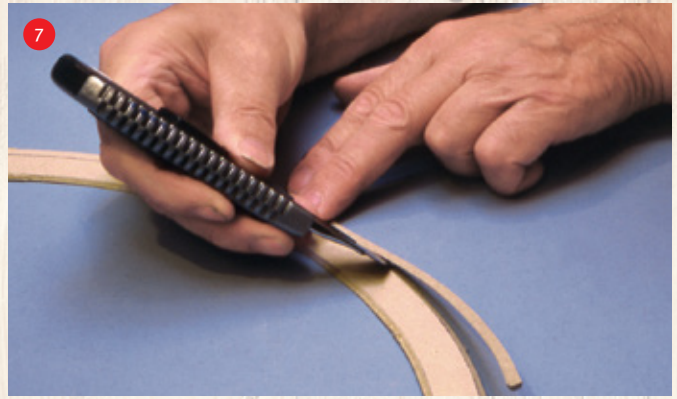
Mit einem scharfen Bastelmesser werden die Bettungsteile genau entlang der aufgezeichneten Schnittlinien ausgeschnitten. Dabei ist ein 45-Grad-Böschungswinkel anzustreben. Außerdem sollte das Messer nicht entgleiten, denn Schnittverletzungen an der Hand sind schnell geschehen.
