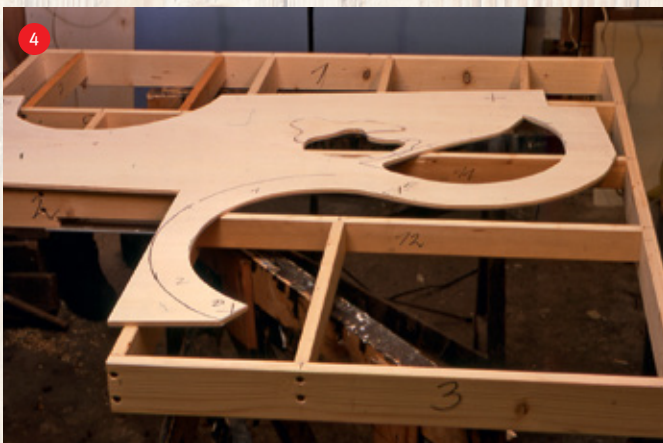
Die Bahnhofstrasse ist hier schon genau nach den Punkten A und D in den Rahmen eingemessen und mit Nägeln leicht befestigt. Die Lage der Punkte B, C und E ergibt sich von selbst, sollte aber dennoch nachgemessen und kontrolliert werden.
