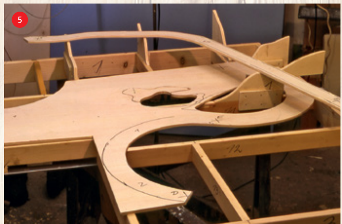
So sieht unsere Bahnhofstrasse im gegenwärtigen Baustadium aus, wenn sie plangerecht und exakt nach den Anweisungen der Liste „B“ einjustiert wurde. Auch die Spanten sind eingebaut und die Dammtrasse aufgelegt. Fehlen nur noch die beiden Wendeltürme, die in der nächsten Folge behandelt werden.
