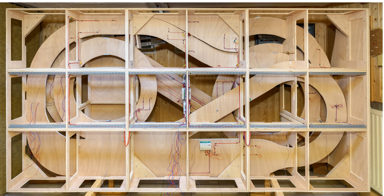
Gut geplant: Trotz ihrer kompakten Ausmaße können wir unsere Anlage auf die Seite kippen – so fällt das Verkabeln leichter.
