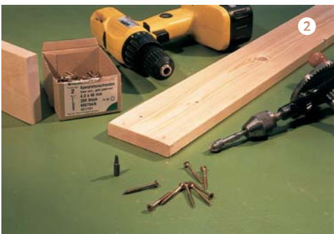
Damit sich beim Eindrehen der Schrauben die Holzenden nicht spalten, werden die Schraublöcher vorgebohrt und mit einem Senker passende Kopfrichter ausgerieben.
