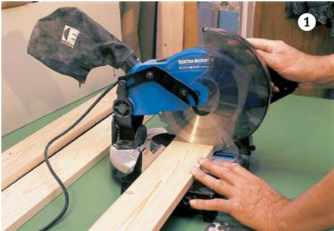
Schnell und präzise sind die Rahmenbretter mit einer Kappsäge abgelängt. Für saubere Schnittkanten und exakte Winkel genügt jedoch auch eine preisgünstigere Winkelanschlag-Gehrungssäge.
