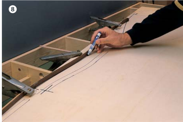
Eine elastische Holz- oder Kunststoffleiste hilft den gewünschten Bogenverlauf im Flexgleis-Bereich anzuzeichnen. Markiernadeln oder 20-er-Nägeln halten die Leiste in der vorgesehenen Krümmung fest.
