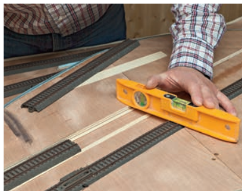
Dazu werden sie an der Bettungskante eingesägt und um das nötige Maß nach unten gedrückt.
