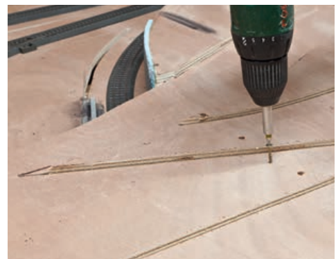
Damit das klappt, müssen auch die Rahmenkanten eingesägt sein. Dann wird alles verschraubt.
